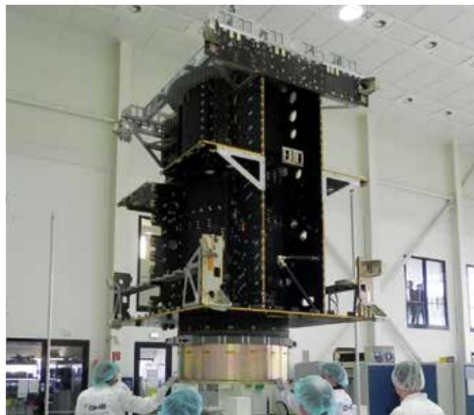
*Banc optique de l'imageur FCI (ci-dessus) et modèle thermique/structurel de la plateforme MTG dans les locaux de l'industrie (à droite)*
