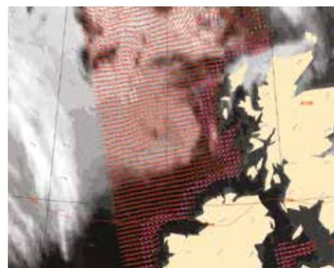
*Champ de vent à résolution 12,5 km extrait des observations ASCAT par le SAF Océans et glaces de mer (en rouge) superposé à l'imagerie infrarouge Meteosat et aux vents prévus par un modèle de prévision numérique du temps (en bleu)*
